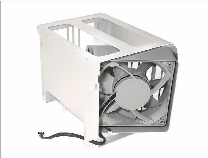
ⓘ Nota de sustitución: Si vas a instalar un nuevo ventilador en el conjunto de la jaula de memoria, gira el ventilador dentro de la jaula tal y como se muestra en la ilustración. Observe también cuidadosamente la orientación del ventilador en relación con la jaula.
