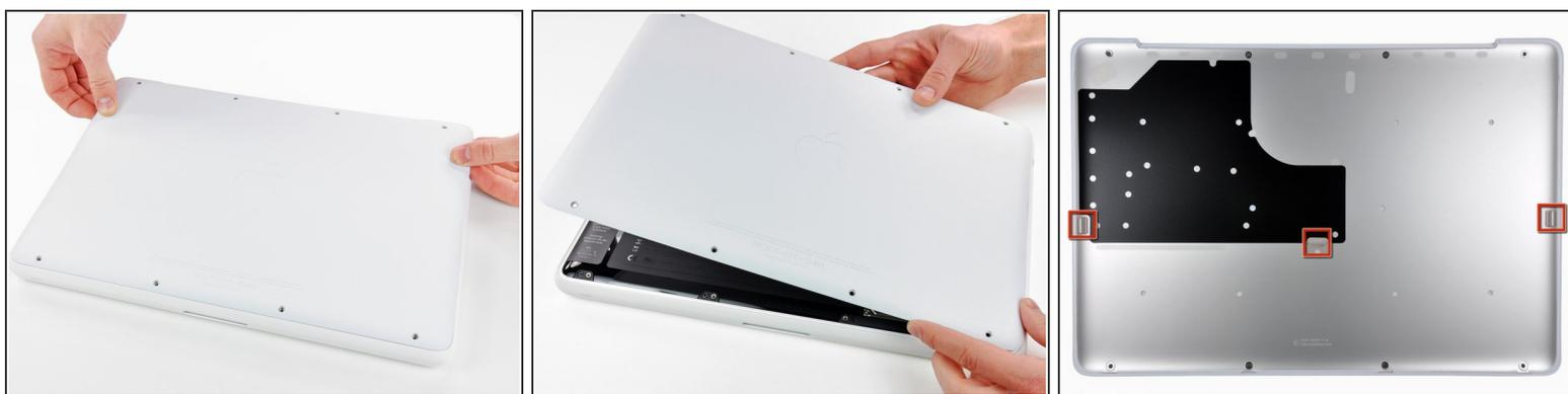
**⚠** La carcasa inferior está construida de aluminio recubierto de goma. No doble excesivamente el aluminio durante la extracción, ya que cualquier deformación permanente causará problemas de tolerancia después del reensamblaje.
