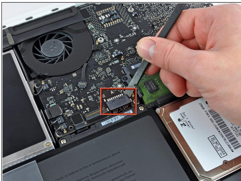
**⚠** Por precaución, aconsejamos que desconectes el conector de la batería de la placa lógica para evitar ninguna descarga eléctrica. Este paso es opcional y no es requerido.
