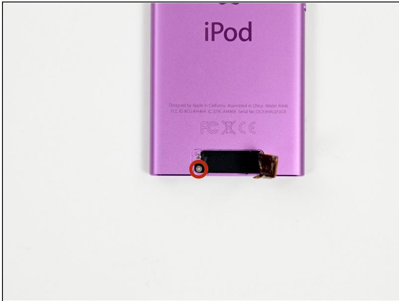
① Dobla suavemente la antena Bluetooth hacia la derecha, fuera del camino de los tornillos en la parte inferior del dispositivo.
