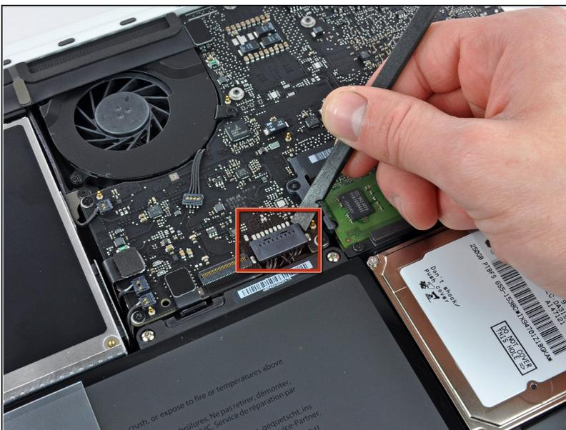
**⚠** Por precaución, aconsejamos que desconectes el conector de la batería de la placa lógica para evitar ninguna descarga eléctrica. Este paso es opcional y no es requerido.
