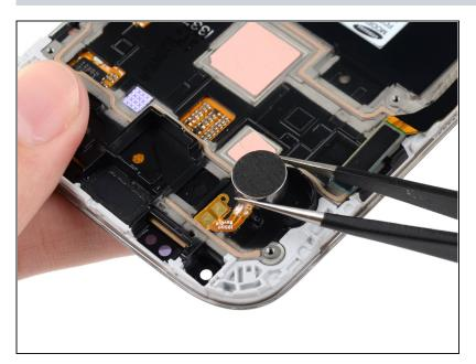
Remueve el vibrador de la parte trasera del ensamblaje de pantalla.
