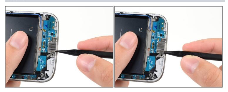
• Con cuidado inserta la punta de un spudger entre el puerto USB y el soporte del puerte USB para levantar un lado del soporte de su poste.
