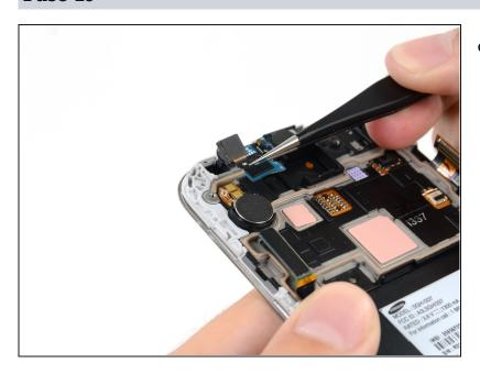
Remueve la cámara frontal del ensamblaje de pantalla.
