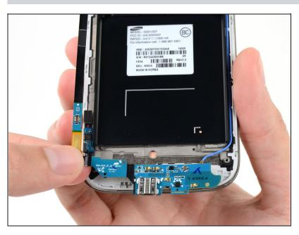
Remueve la placa USB del ensamblaje de pantalla.
