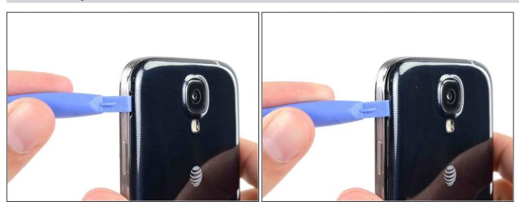
Haz palanca con una herramienta de apertura de plástico o tu uña en la ranura a la izquierda de la cámara trasera cerca del botón del encendido.
