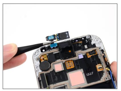
Remueve el ensamblaje del altavoz auricular del ensamblaje de pantalla.
