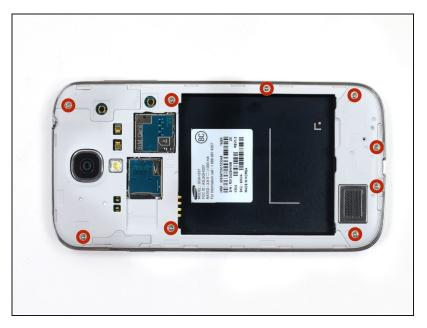
Remueve los nueve tornillos Phillips #00 de 4.00 mm que sujetan el marco medio al ensamblaje de pantalla.
