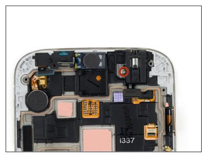
Remueve el único tornillo Phillips #00 de 2.4 mm que sujeta el ensamblaje de toma de auriculares al ensamblaje de pantalla.
