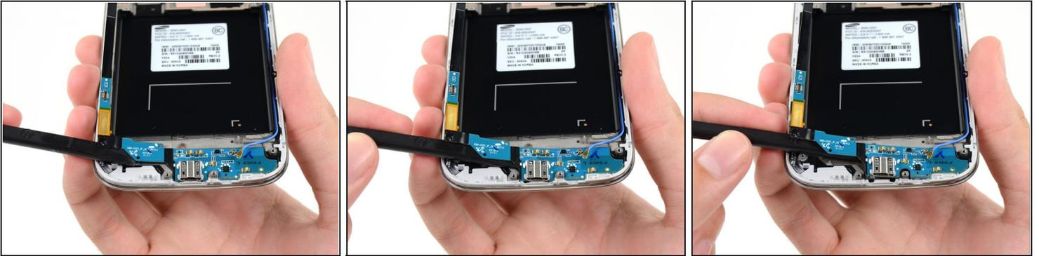
ⓘ La placa USB está sujeta al ensamblaje de pantalla con un ligero adhesivo.
