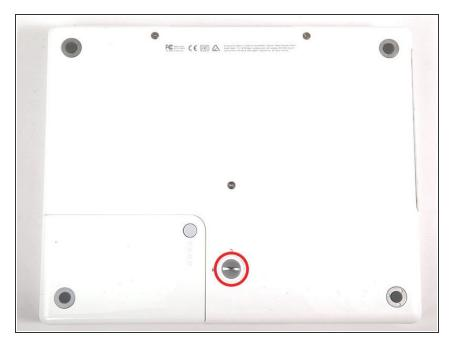
Utilisez une pièce pour faire tourner la vis qui verrouille la batterie, de 90 degrés dans le sens des aiguilles d'une montre.
