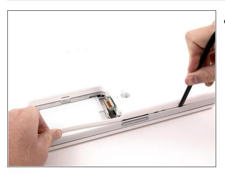
Passez une spatule le long de la jointure entre le boîtier supérieur et le boîtier inférieur à l'avant de l'ordinateur pour détacher les attaches du boîtier inférieur. Tirez le boîtier inférieur vers le haut et déplacez la spatule autant que nécessaire jusqu'à entendre trois clics distincts.
