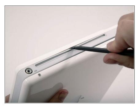
Il y a trois attaches au niveau du lecteur optique que vous devez détacher avant que le boîtier inférieur sorte. Passez une spatule le long du boîtier inférieur, audessus de la fente du lecteur optique et déplacez-la vers l'arrière du boitier jusqu'à entendre trois clics distincts.
