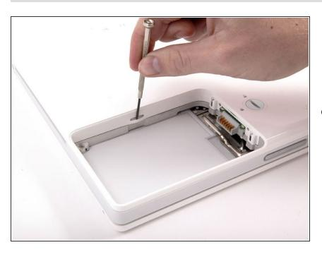
• Une petite fente dans le rebord du compartiment de la batterie bloque le boîtier inférieur. Utilisez un petit tournevis plat pour pousser la partie inférieure de cette fente, puis poussez vers le haut pour dégager cette fente des attaches qui la retiennent.
