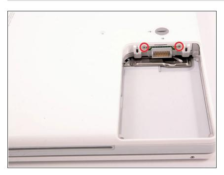
Dévissez les deux vis cruciformes de part et d'autre des contacts de la batterie.
