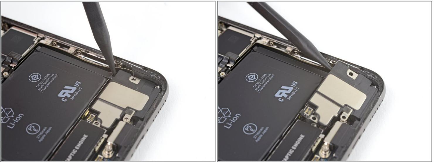
⚠ Al levantar el altavoz, ten cuidado de no dañar el cable flexible que has desconectado. Si es necesario, sosténlo hacia un lado así el altavoz tiene espacio para salir.
