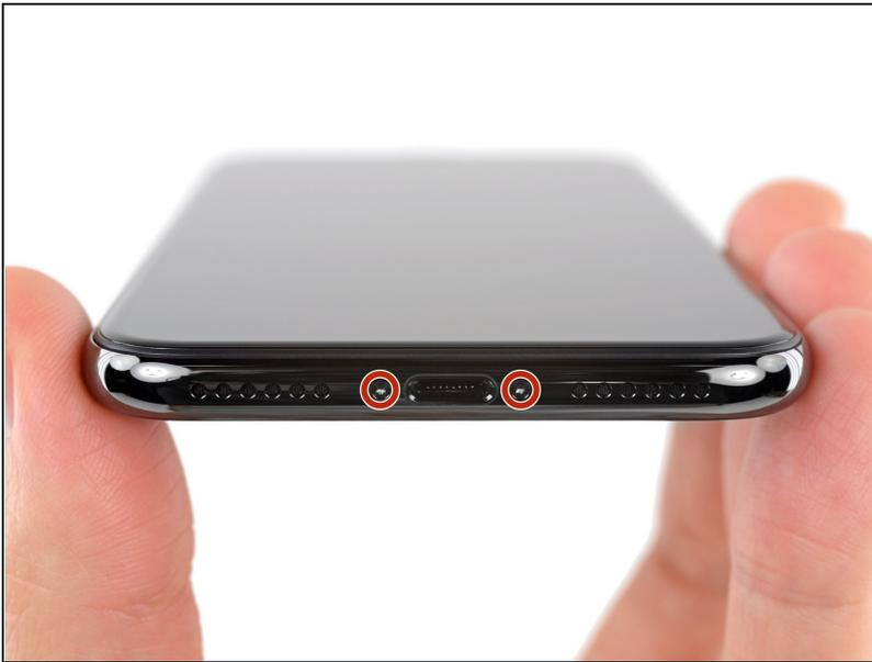
**⚠** Antes de comenzar, descarga la batería de tu iPhone por debajo de un 25%. Una batería de litio cargada puede producir fuego o explotar si la pinchamos accidentalmente
