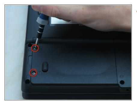
Afloja los dos tornillos cautivos en la esquina inferior izquierda del disco duro con un destornillador Phillips n.
