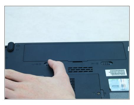
Desliza el pestillo del compartimento izquierdo de la batería hacia la izquierda.
