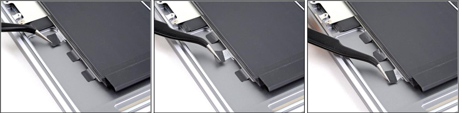
ⓘ Las celdas de la batería del MacBook están sujetas a una bandeja metálica como un conjunto completo, que se adhiere a la carcasa con un total de seis tiras adhesivas extensibles.
