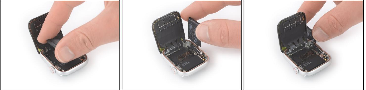
**⚠** El cable flexible de la batería es lo suficientemente largo como para permitirte colocar la batería fuera de la caja del reloj, pero evita tensar el cable cuando levantes la batería de su hueco.
