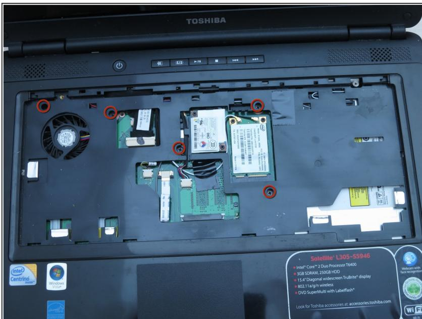
**⚠ PRECAUCIÓN:** no permitas que entren hardware o residuos en el conducto y el ventilador de la CPU.
