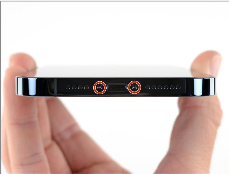
**⚠ Precaución:** Antes de empezar, descargue la batería de su iPhone por debajo del 25%. Una batería de iones de litio cargada puede incendiarse y/o explotar si se pincha accidentalmente.
