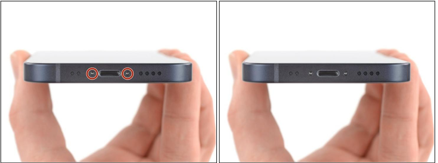
**⚠** Antes de empezar, descarga la batería de tu iPhone por debajo del 25%. Una batería de iones de litio cargada puede incendiarse y/o explotar si se pincha accidentalmente.
