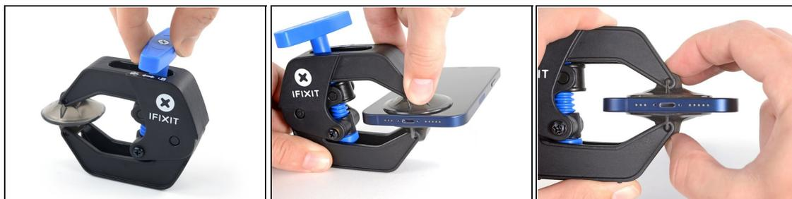
**i** Los siguientes dos pasos demuestran el Anti-Clamp, una herramienta que diseñamos para facilitar el procedimiento de apertura. **Si no estás utilizando Anti-Clamp, salta tres pasos hacia abajo para obtener un método alternativo.**
