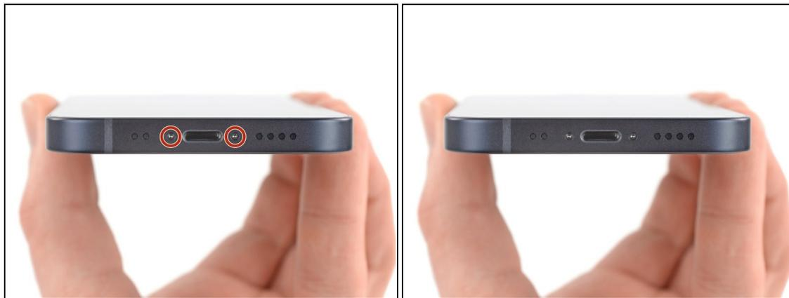
**⚠** Antes de empezar, descarga la batería de tu iPhone por debajo del 25%. Una batería de iones de litio cargada puede incendiarse y/o explotar si se pincha accidentalmente.
