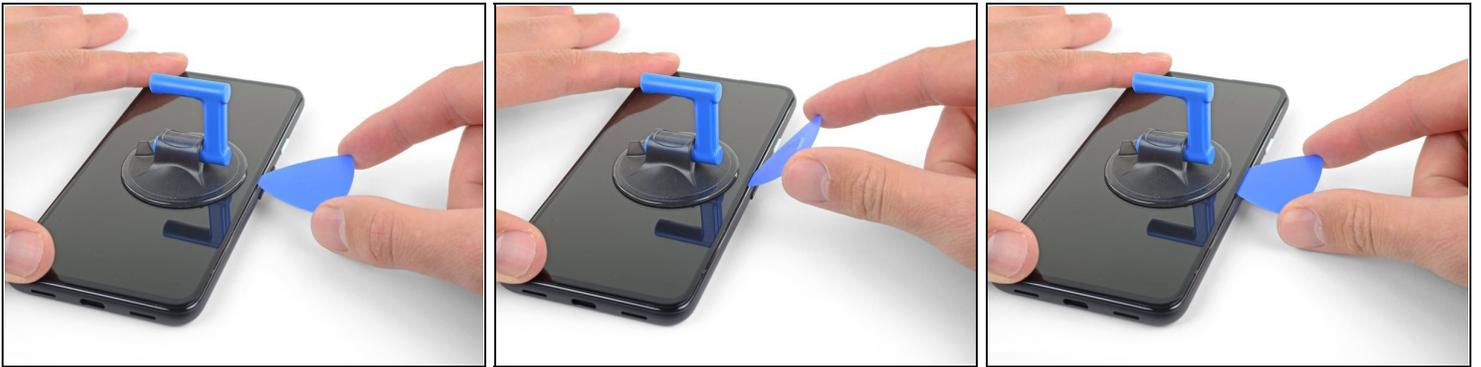
ⓘ Este paso muestra cómo insertar la púa sin dañar el panel OLED. Haz esto antes de empezar a cortar el adhesivo.
