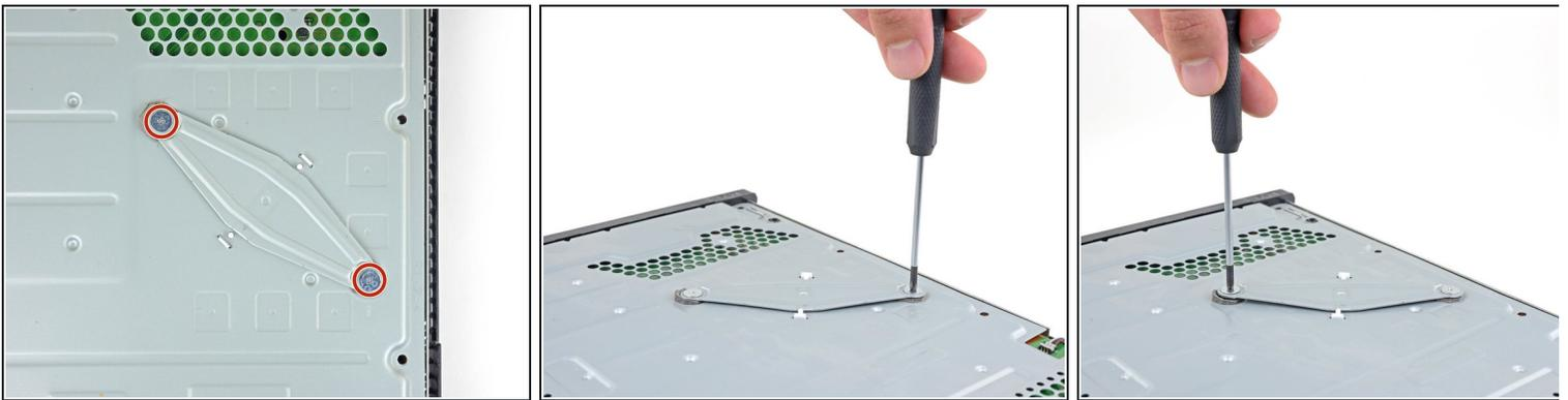
**i** Este paso te muestra cómo desenroscar correctamente la placa de presión.
