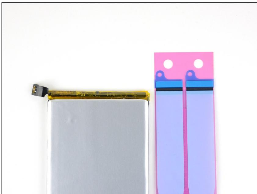
**i** Las tiras adhesivas de liberación elástica se aplicarán en la parte posterior de la batería de reemplazo, y puede ser necesario cortarlas a la medida.
