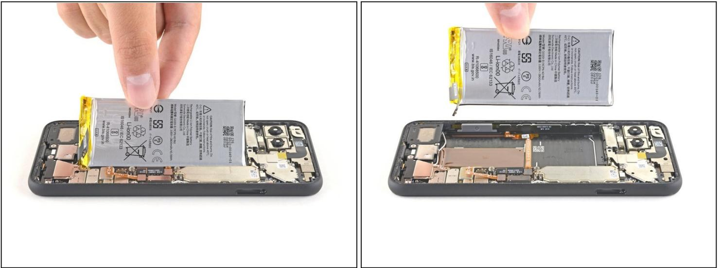
**⚠ No reutilices la batería si se ha deformado o dañado, ya que hacerlo es un peligro potencial para la seguridad. Reemplázala con una batería nueva.**
