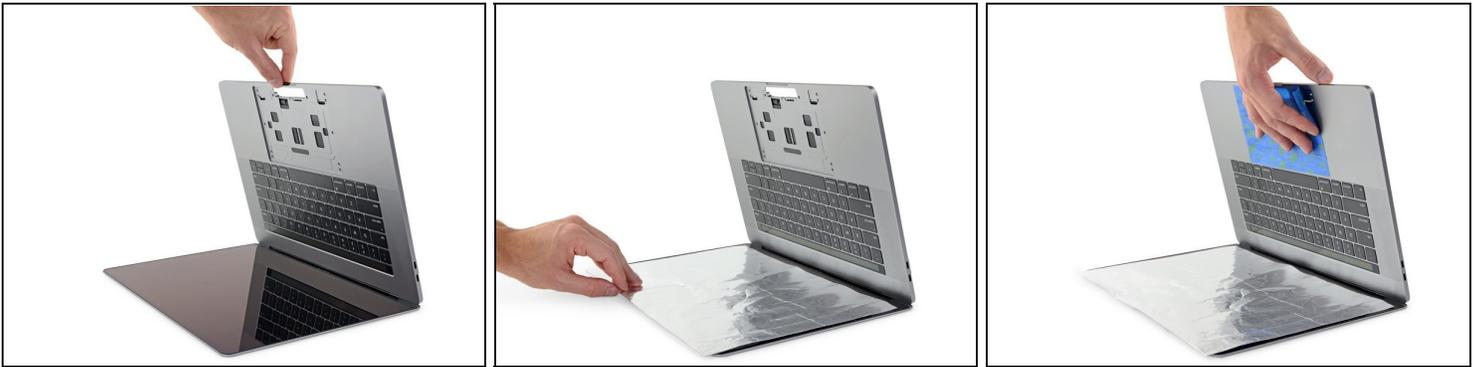
**⚠ El removedor líquido de adhesivos que se incluye en el kit puede dañar el revestimiento antirreflejos de la pantalla de tu MacBook Pro, así como las teclas de plástico del teclado.**
