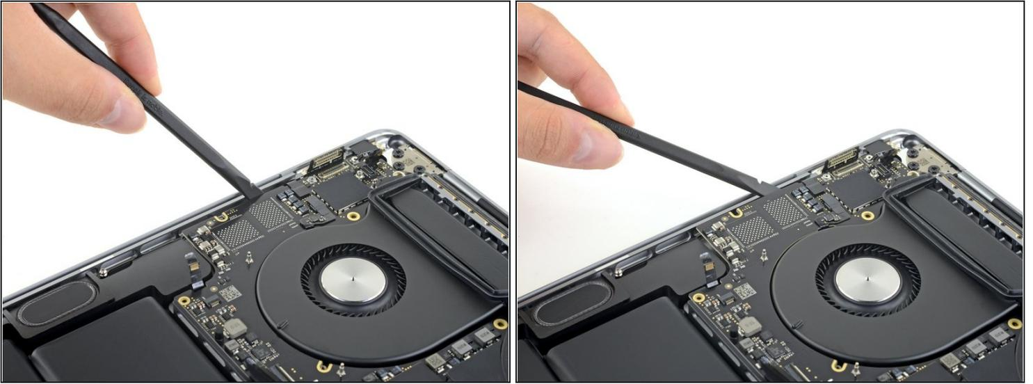
ⓘ El ensamblaje de la placa lógica está muy ajustado, pero puede hacer más fácil su extracción insertando un spudger bajo el borde izquierdo y haciendo palanca ligeramente hacia **arriba**.
