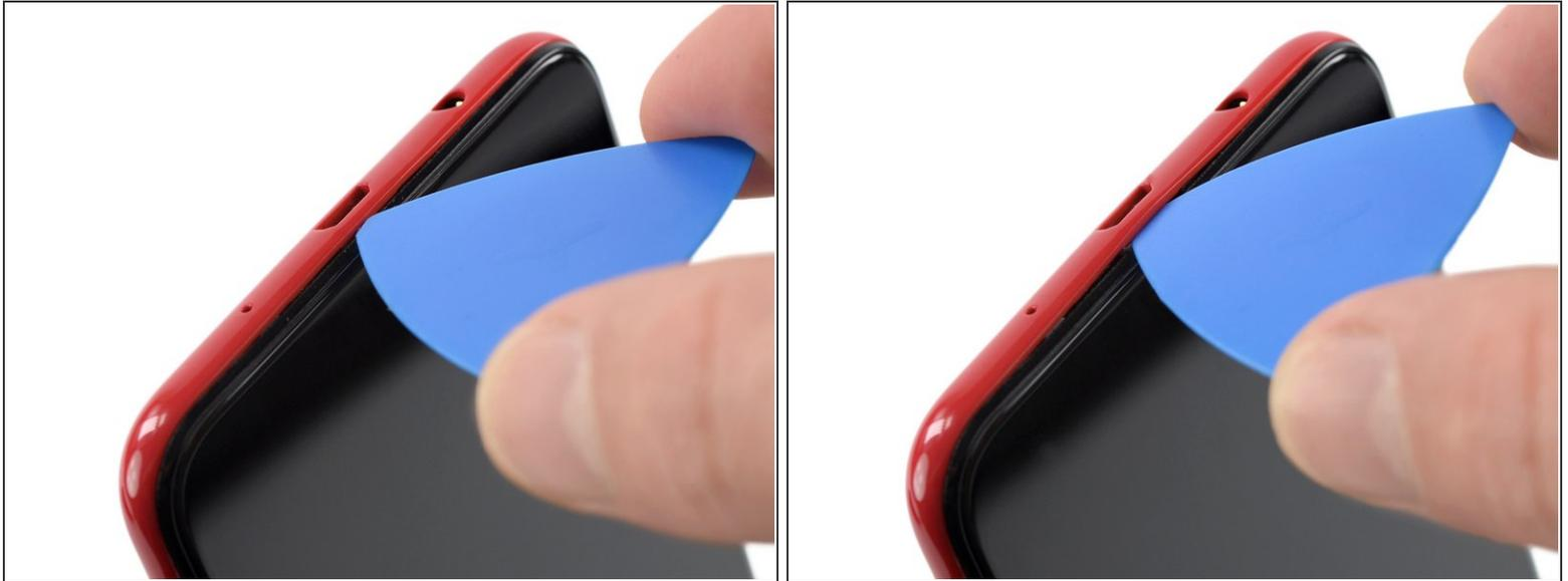
**i** La cubierta posterior se mantiene en su lugar mediante clips de plástico.
