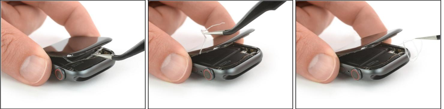
**⚠ Para evitar tensar los cables de la pantalla, no abras la pantalla completamente todavía.**
