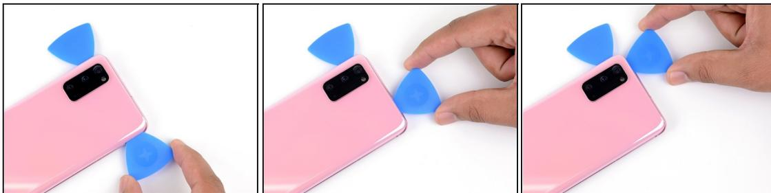
**⚠** El cristal cerca de las esquinas de la tapa trasera es curvo y muy susceptible de agrietarse. Sea cuidadoso durante este paso para evitar dañar la cubierta trasera.
