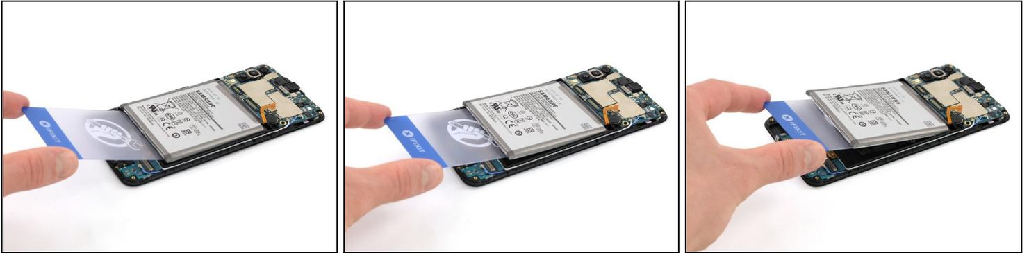
**⚠ Haz lo posible por no deformar la batería durante este proceso. Las baterías de iones de litio de caparazón blando pueden tener fugas de productos químicos peligrosos, incendiarse o incluso explotar si se dañan. No emplees una fuerza excesiva ni hagas palanca en la batería con herramientas metálicas.**
