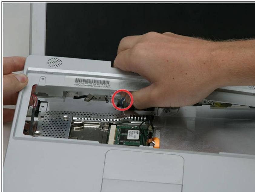
**⚠** Die Stecker an den Kabelenden stecken sehr fest in ihren Anschlüssen auf dem Logic Board. Wenn du direkt am Kabel ziehst, löst sich entweder der Stecker vom Kabel oder der Anschluss vom Logic Board.
