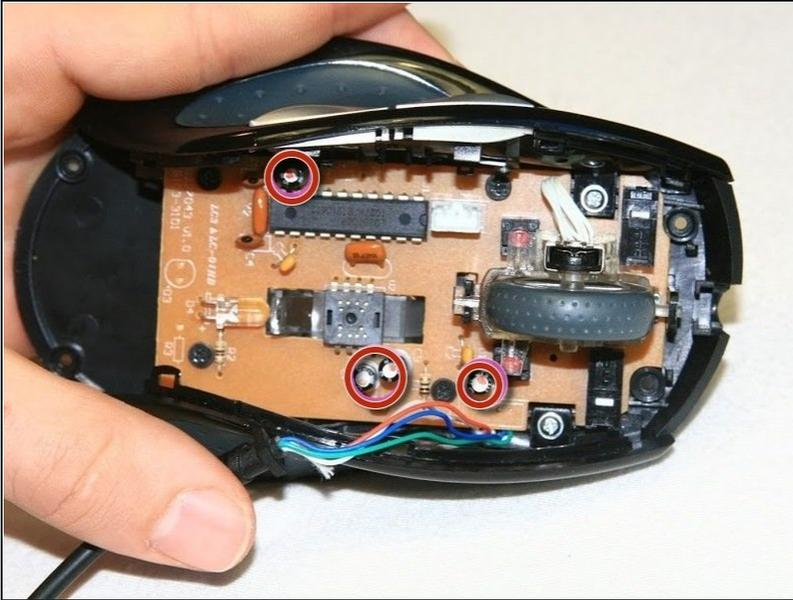
⚠ Los condensadores de esta placa pueden liberar energía eléctrica almacenada si se tocan.
