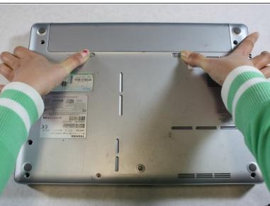
Desliza ambos pestillos hacia afuera para liberar la batería.
