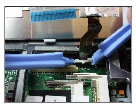
Con las herramientas de apertura de plástico, extrae el segundo cable plano del resto de la computadora.
