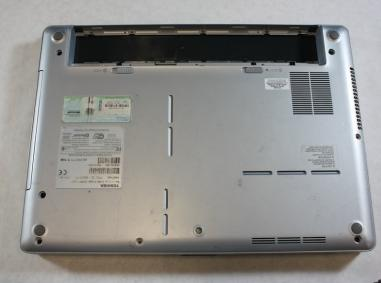
Extrae la batería levantando la tapa de la batería para sacarla de la computadora portátil.
