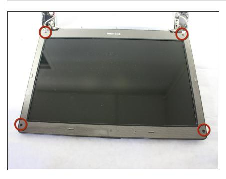
Retira los cuatro tornillos Philips #00 de 4,85 mm ubicados en cada esquina de la pantalla.
