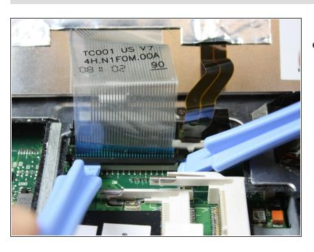
Con las herramientas de apertura de plástico, saca el cable plano del resto de la computadora.
