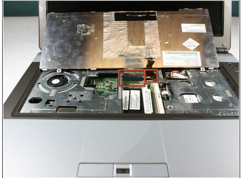
**⚠** Al retirar el teclado, ten cuidado de no rasgar el cable plano que conecta el teclado a la computadora, para evitar dañarlo.
