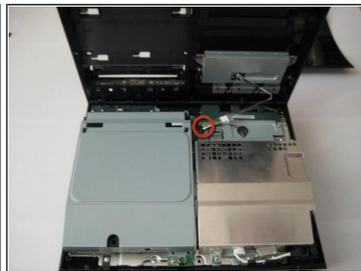
**⚠ LEE ESTO ANTES DE REALIZAR EL SIGUIENTE PASO Y DEL PROCEDIMIENTO.** Localiza las dos pestañas en la parte trasera de la PS3, presiónalas al mismo tiempo y levanta la carcasa exterior para quitarla de la placa principal **PERO**, ten cuidado ya que hay un cable plano conectando la carcasa a otro hardware.
