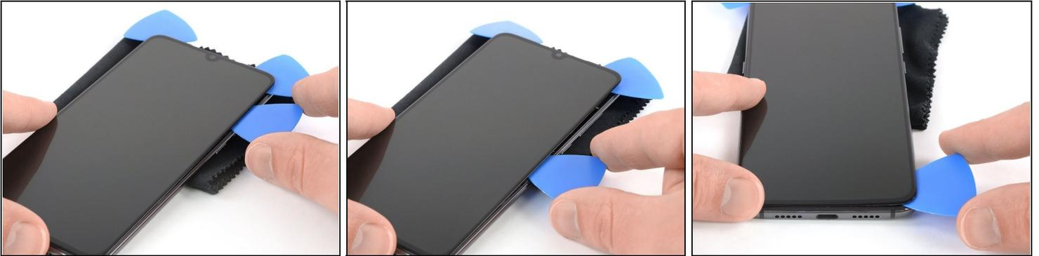
① [Aplica más calor](#) si el adhesivo se vuelve difícil de cortar.
