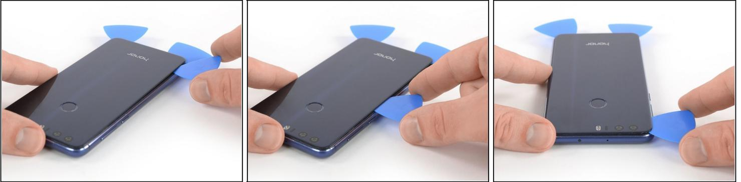
**⚠** El cable de huellas digitales se encuentra encima de los botones de encendido y volumen en este lado del teléfono. Utiliza únicamente la punta de la púa de apertura en esta zona para evitar daños.
