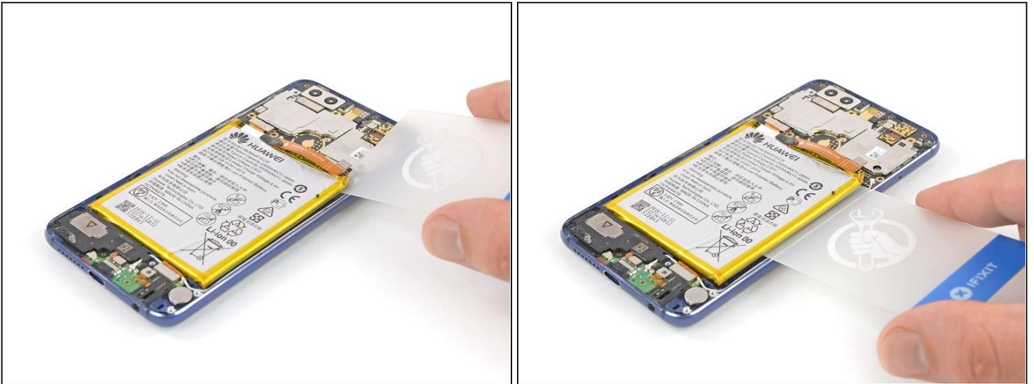
**⚠** Intenta deformar la batería lo menos posible durante el siguiente proceso. Las baterías de iones de litio de cáscara blanda pueden tener fugas de productos químicos peligrosos, prenderse fuego o incluso explotar si están dañadas. No utilices fuerza excesiva ni hagas palanca en la batería con herramientas metálicas.
