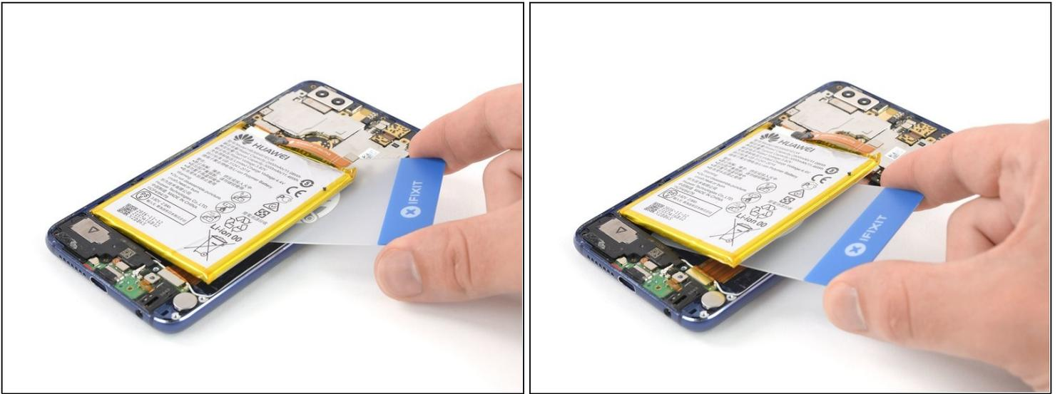
**⚠ El cable flexible de la pantalla y el cable flexible de interconexión pasan por debajo de la batería. Ten cuidado de no dañarlos mientras cortas el resto del adhesivo.**
