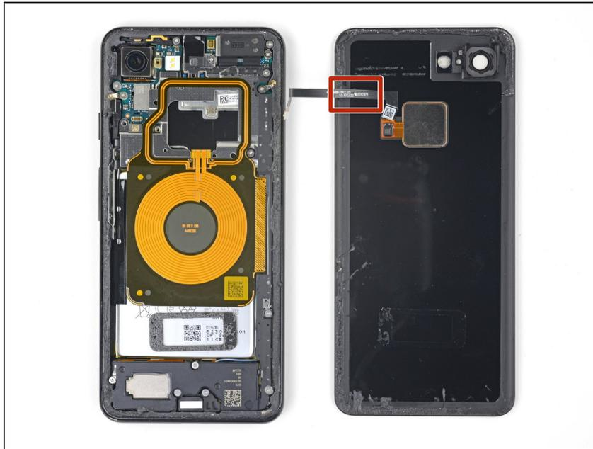
**⚠** Al insertar una púa de apertura sobre el botón de encendido, ten cuidado de no insertar la púa demasiado profundamente o dañarás el cable del sensor de huellas dactilares.
