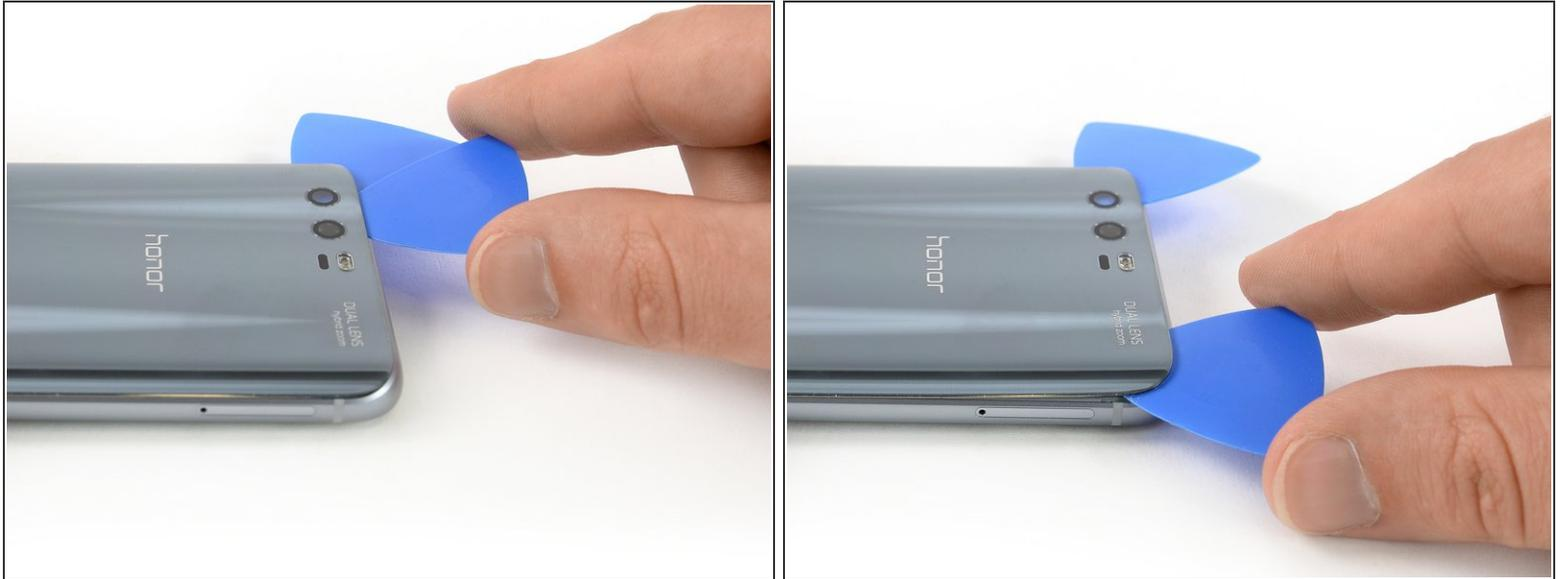
**i** Si el adhesivo se hace difícil de cortar, es probable que esté demasiado frío. [Usa tu iOpener](#) para recalentarlo.
