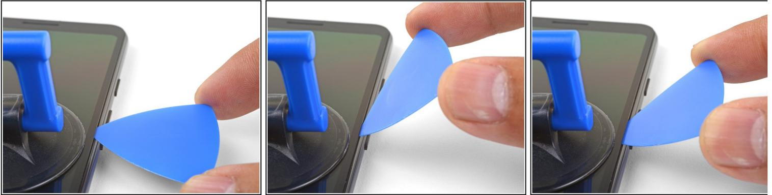
**i** Este paso muestra cómo insertar la púa sin dañar el panel OLED. Haz esto antes de cortar los bordes largos del teléfono.
