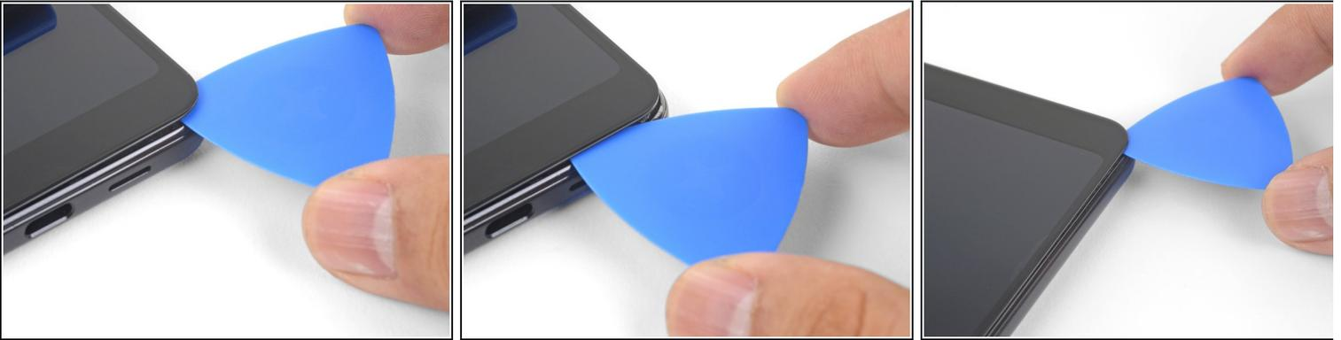
**i** Al cortar alrededor del borde inferior del teléfono, no insertes a la púa más de 6 mm.
