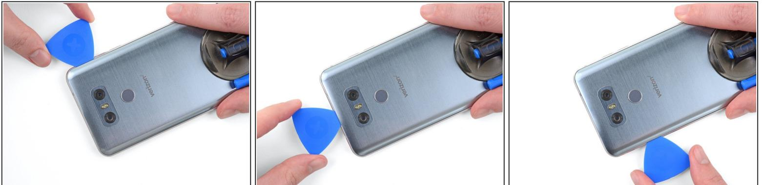
**⚠** Como se ve en el [Paso 1](#), el cable del lector de huellas digitales corre a la izquierda de la cámara, bastante cerca del borde del teléfono. Ten cuidado al cortar el adhesivo en los bordes superiores del teléfono.
