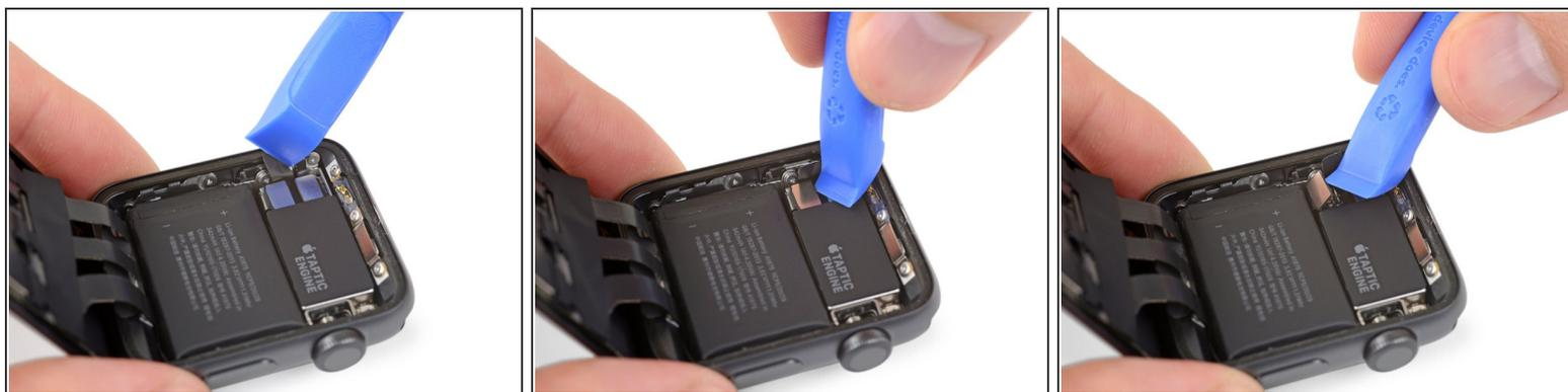
**i** En la versión solo GPS es posible desconectar la batería inmediatamente. Para la versión celular/LTE, primero debes desconectar la junta Force Touch y apartarla para desconectar la batería.
