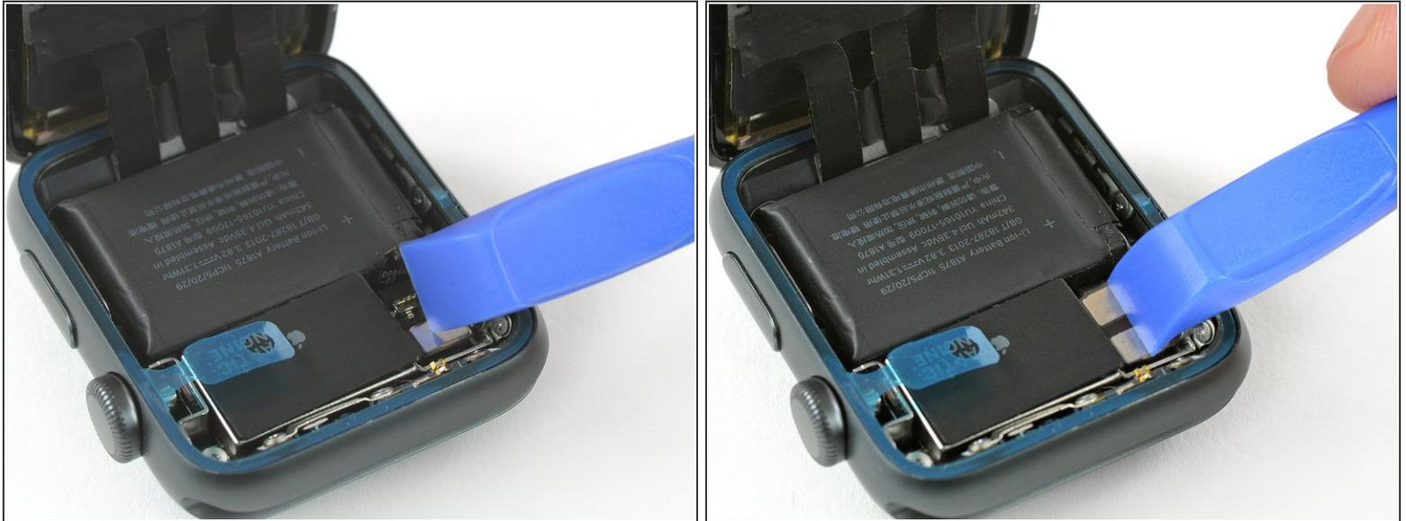
**⚠ Asegúrate de que su pantalla esté conectada antes de volver a conectar la batería.**
