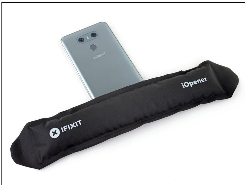
**i** El calentamiento de la parte trasera de la G6 ayuda a suavizar el adhesivo que fija el panel trasero, facilitando su apertura.
