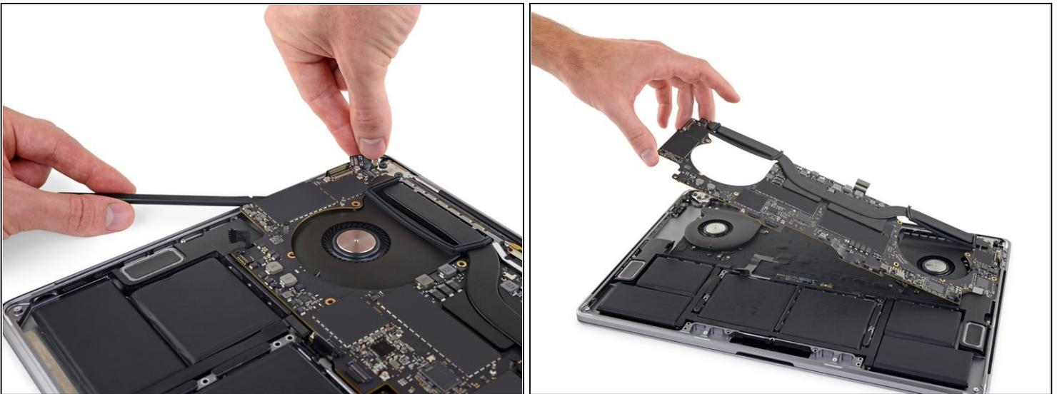
ⓘ El ensamblaje de la placa lógica tiene un espacio muy justo, pero puedes facilitar la extracción insertando un spudger debajo del borde izquierdo y levantándolo ligeramente.
