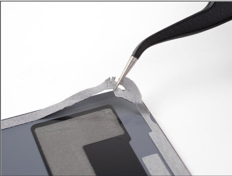
★ [Sigue esta guía](#) para volver a colocar la carcasa trasera y colocar nuevo adhesivo.
