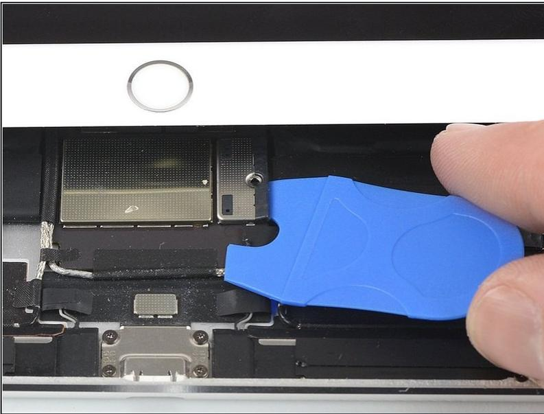
**⚠** Ten cuidado cuando aíslas la batería utilizando un bloqueador de baterías. Los contactos de la batería se doblan o rompen fácilmente, lo que provoca daños irreversibles.
