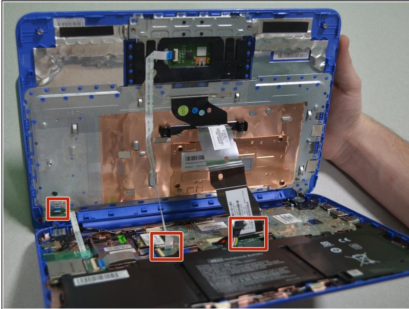
**⚠** Levanta lentamente el teclado ya que hay múltiples cables de cinta que podrían dañarse fácilmente si se levantan con fuerza.
