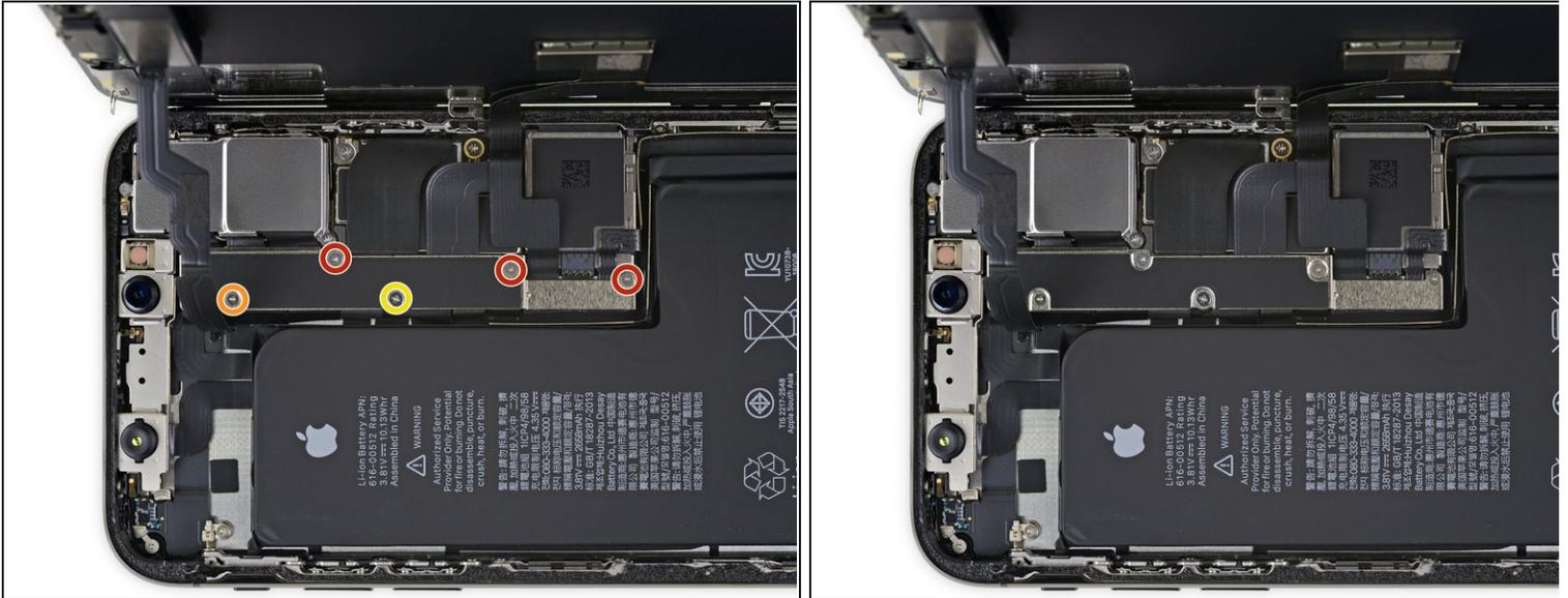
● Remueve los cuatro tornillos Y000 que sujetan el soporte de la cubierta de la placa lógica:
