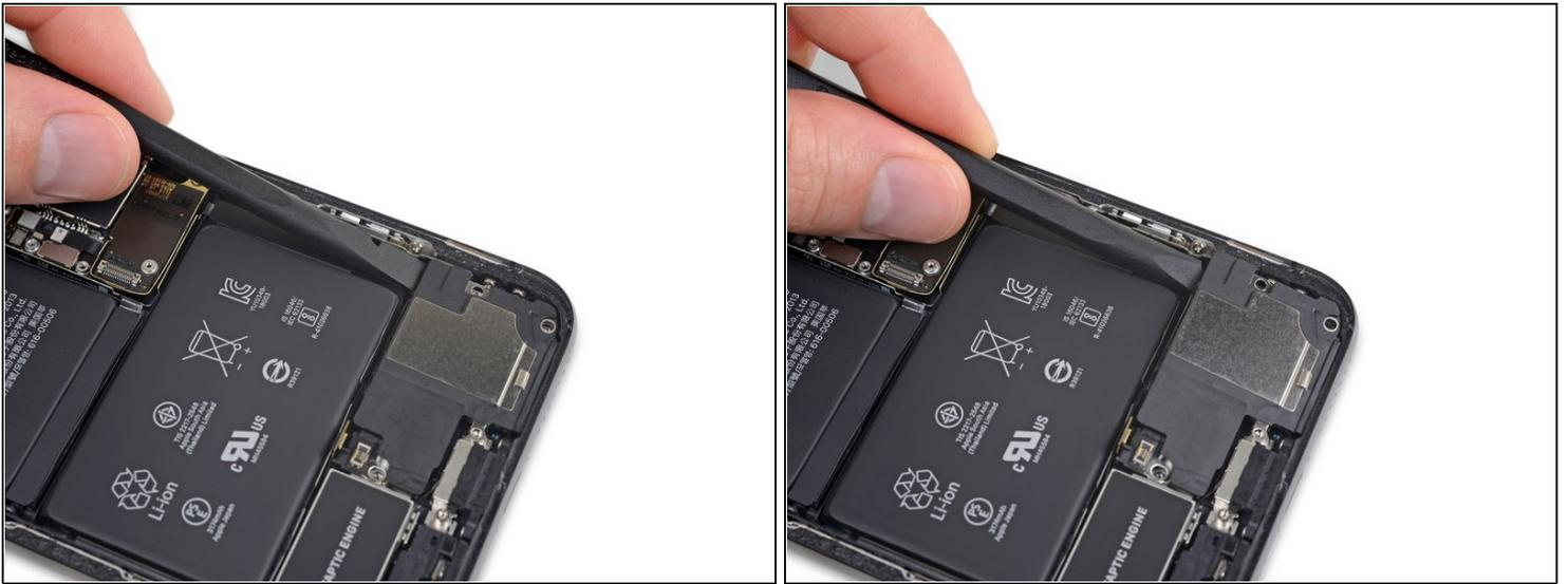
**⚠** Al levantar el altavoz, ten cuidado de no dañar el cable flexible del altavoz que has desconectado. Si es necesario, dobla el cable hacia la batería para que el altavoz tenga espacio para salir.
