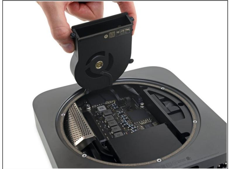
**!** El conector del ventilador está debajo del ventilador y no se puede desconectar hasta que el ventilador se mueva a un lado. No intentes quitar el ventilador completamente todavía.
