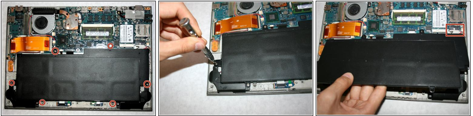
**i** La batería es la pieza rectangular negra en la mitad inferior del dispositivo.
