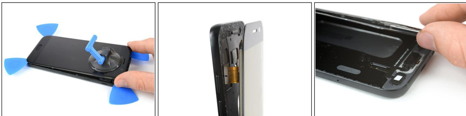
**⚠** No abras el teléfono hasta el final. El cable de la pantalla aún está enroscado a través del marco intermedio y podrías rasgar los cables de los botones de inicio y menú.
