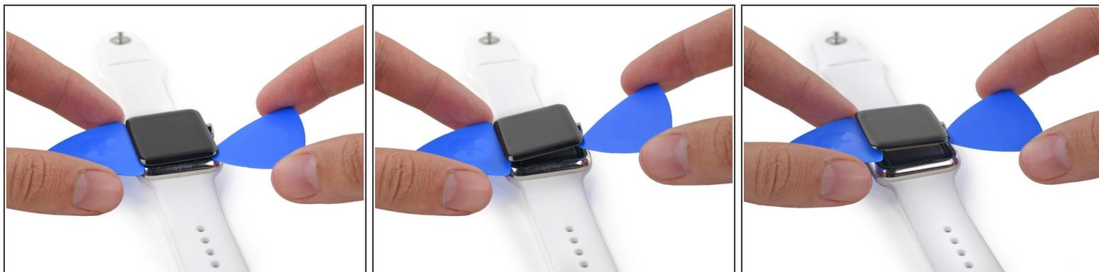
**⚠ Hay dos cables conectando la pantalla al interior del reloj, cerca de la esquina superior izquierda. Ten cuidado cuando hagas palanca o puedes dañar estos cables.**
