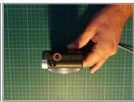
Öffne alle 7 Schrauben mit einem passenden Philips Schraubenzieher
