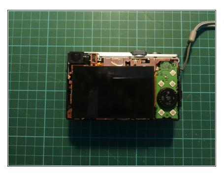
Das hintere Gehäuse ist nun locker und kann entfernt werden. Man sieht das Display und die Steuerung.
