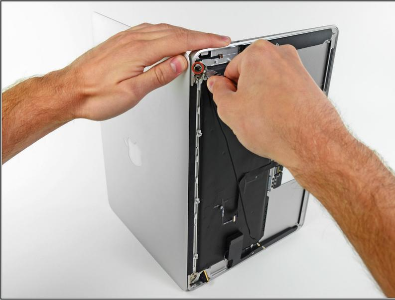
⚠ Antes de quitar el último tornillo de la pantalla, asegúrate de sujetar firmemente la pantalla y la carcasa superior con la otra mano. De lo contrario, los componentes podrían caer sobre la mesa, provocando daños potencialmente costosos.
