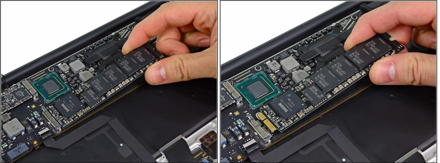
**⚠** Para evitar dañar su zócalo, no levantes excesivamente el extremo del SSD.
